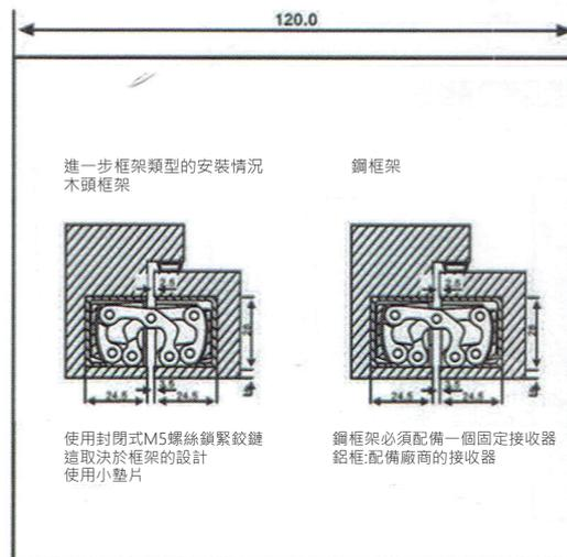
進一步框架類型的安裝情況
