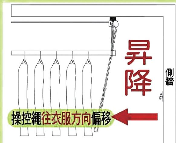
輕拉操控繩，煞車輪組會自動鬆開繩子，晒衣桿即可自由昇降(下降時手可輕握繩子，以控制晒衣桿下降的速度)。
