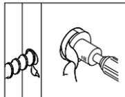
依所標示記號在門面上鑽直徑54mm(2-1/8")的鎖體孔，並在門厚中心鑽直徑25.4mm (1")的鎖門孔。
